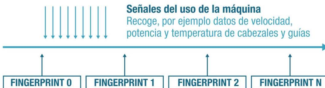
Para la recogida de información se utiliza *hardware* capaz de conectarse a diferentes CNC de máquina herramienta, además de recoger información proveniente de la sensórica que se pueda instalar en máquina.
