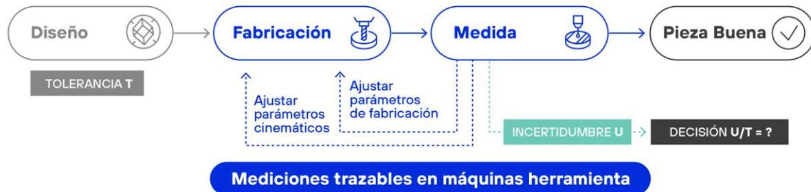
Figura 3. Estrategia “cero defectos” basada en la medición por coordenadas en máquina herramienta. (Fuente: Tekniker)
