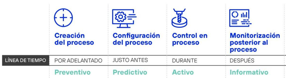
Figura 2. Medición en máquina en diferentes etapas del proceso de fabricación. (Fuente: Renishaw)
